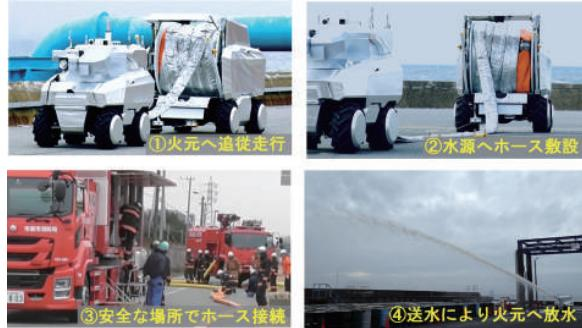
図2 放水砲ロボットとホース敷設ロボットによる火炎への放水
