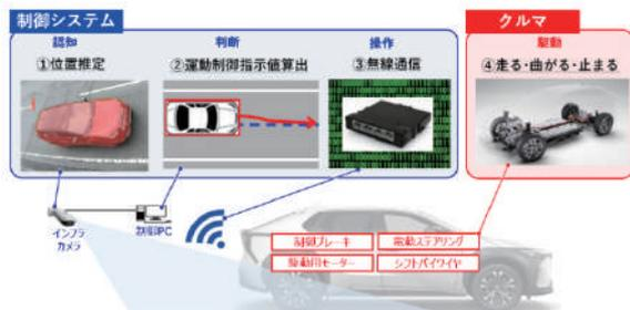
図2 RCDシステム制御概要
