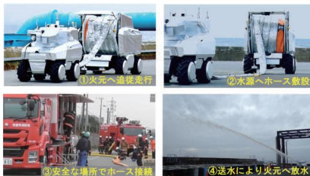
図2 放水砲ロボットとホース敷設ロボットによる火災への放水
