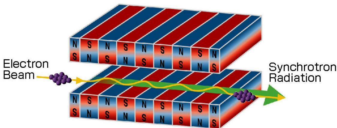
図3 アンジュレータからの放射光
