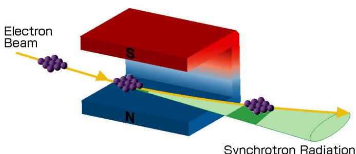
図2 偏向電磁石からの放射光
