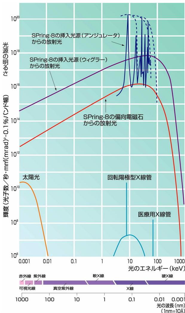
図4 SPring-8放射光のスペクトル
