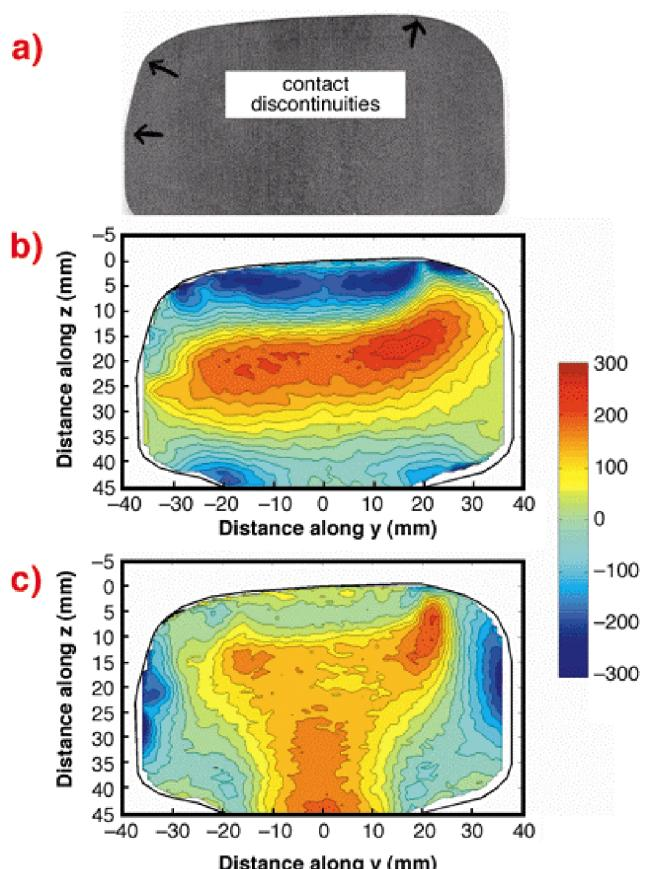
図9 レールの残留応力分布
