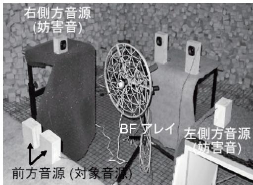
図8 アレイ側方からの吸遮音性能試験
