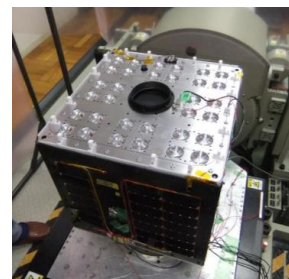
写真1 振動試験の様子(フライトモデル)
