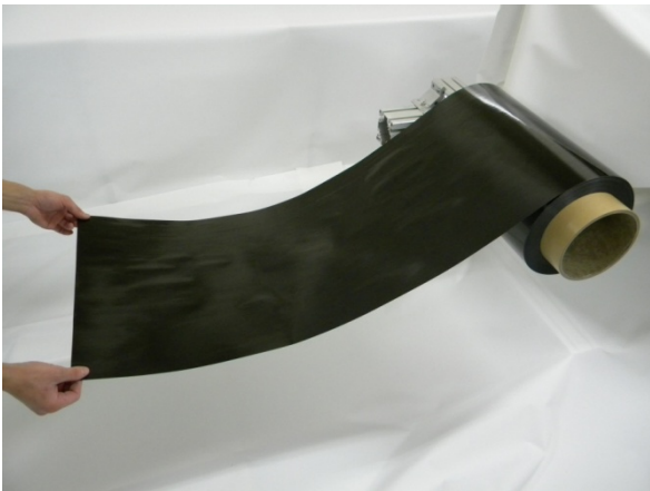
写真-1 開発した熱可塑性薄層プリプレグシート
