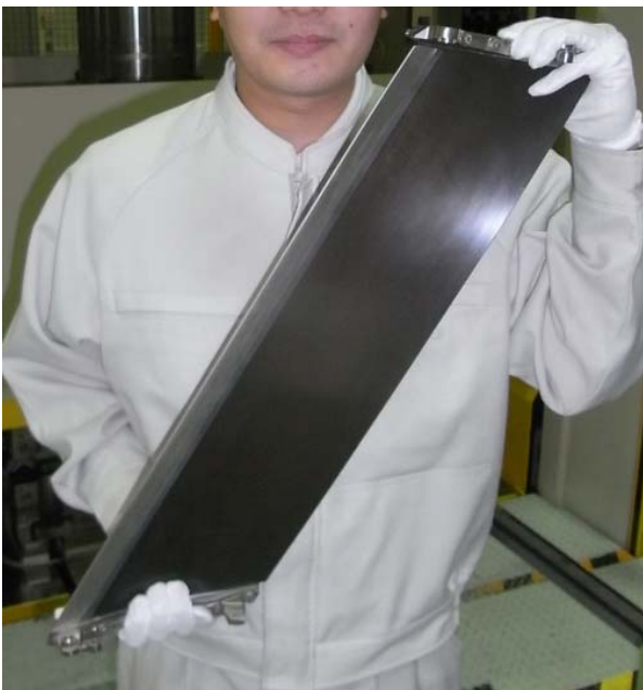
写真-2 「PW1100G-JM」用の複合材構造案内翼(SGV) (株IHI 資料)
