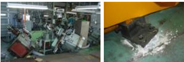
写真5 工作機械の転倒とアンカーボルトの破損
