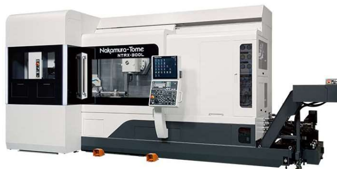
図-7. 複合作業機械：NTRX300L
