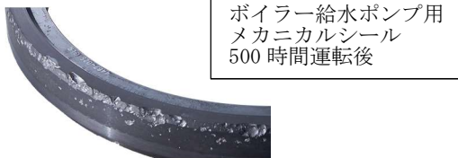
図-1, ボイラー給水ポンプで損傷を受けたSiC
