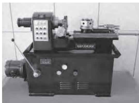
図 2 油圧自動タレット旋盤 NT5 型(昭和 38 年)
