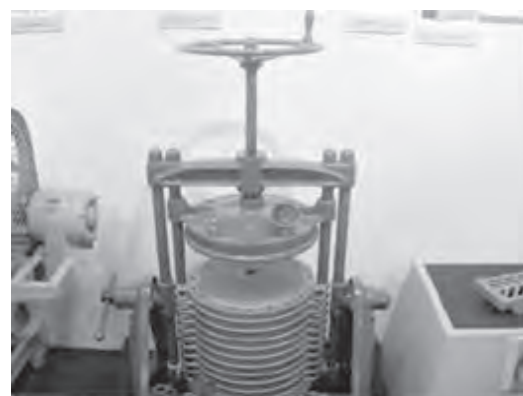
図5 堅型セライト濾過器(昭和30年)
