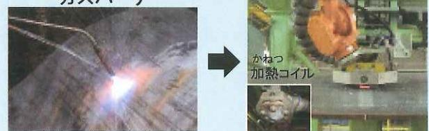
職人さんは、ガスバーナーで加熱を行いますがこのシステムでは入熱管理、加熱制御が簡単な高周波電磁誘導加熱装置を導入しました。
