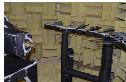
図 4 ノズル縮小模型と音響計測装置
