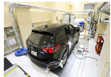
図2 シャシダイナモメータを使った車両の計測
