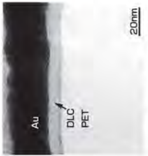
図1 断面からの透過型電子顕微鏡による観察
