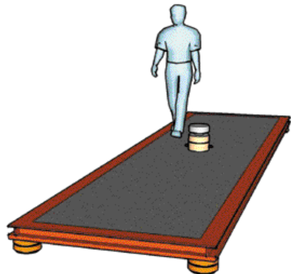
図1 床制振用アクティブ動吸振器
