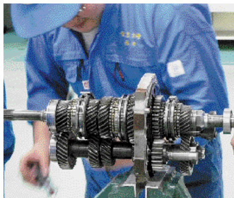
図1 マニュアル・トランスミッションの分解と組み立て
