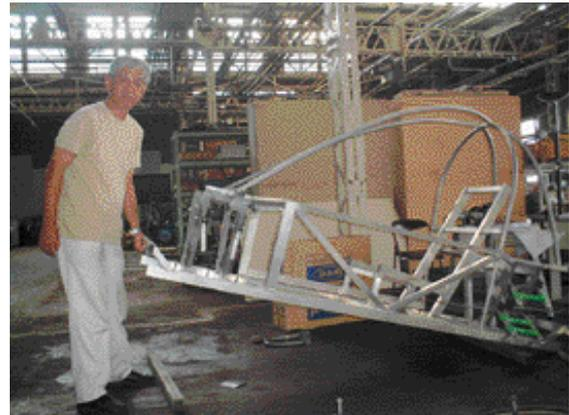
図1 マグネシウム製軽量フレーム
