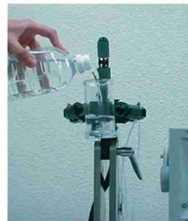
図2 すべり覚センサによる適切な把持力制御
