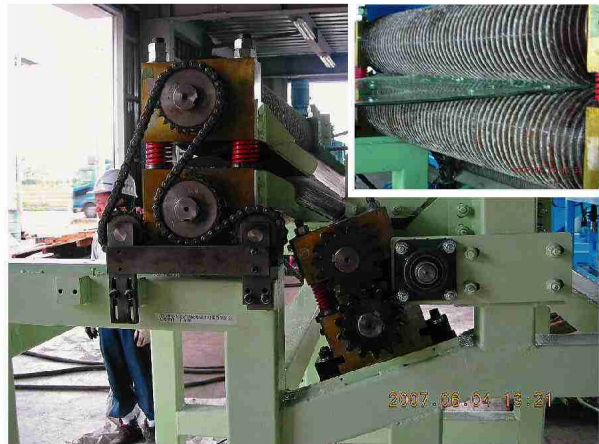
図2 合わせガラス破碎分離機 （右上はロールに噛みこむガラス）
