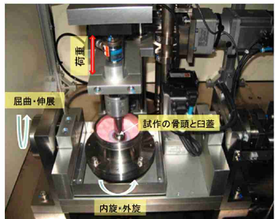
図3 人工股関節シミュレータ試験
