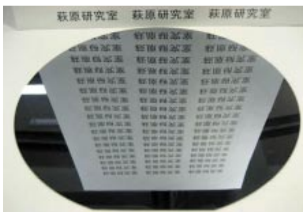
図4 炭砥石で研磨したシリコンウェハ
