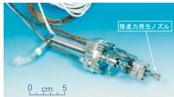
図1 推進力1Nの液体ロケットエンジン
