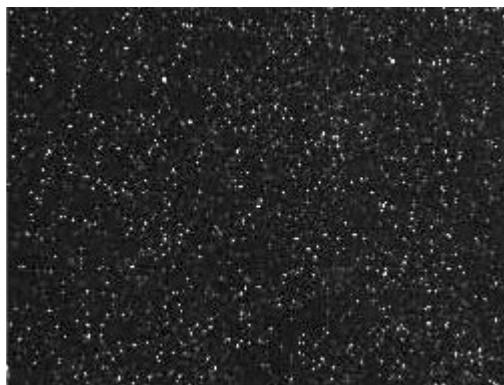
図1 流れの可視化(粒子画像)
