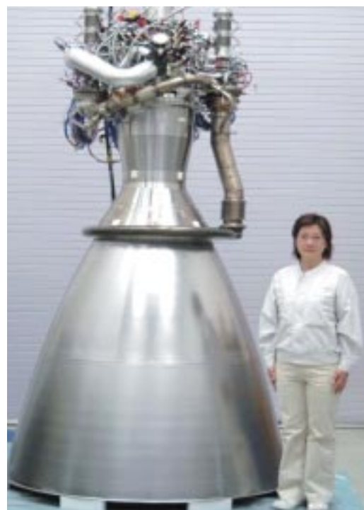
図2 推進力100kNの液体ロケットエンジン
