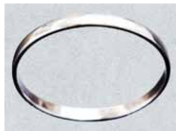
図2 Zr 55 Al 10 Ni 5 Cu 30 金属ガラスで試作した指輪 固体でありながら、溶けた金属のような独特な 光沢を放ちます。
