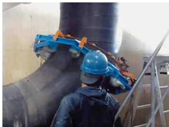
図2 管外面検査用昇降ロボット「のぼるくん」
