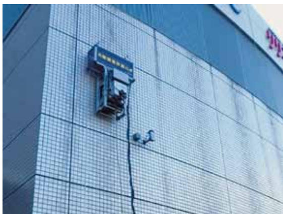
図1 ビル外壁検査点検ロボット「のぼる君Ⅱ」
