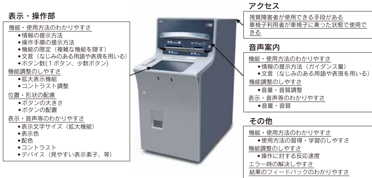
図1 現金自動預け払い機 (ATM) における使いやすさの配慮点 (三樹、細野著 “ITのユニバーサルデザイン” 丸善 (2005)、p.27 図3.3をもとに作成)
