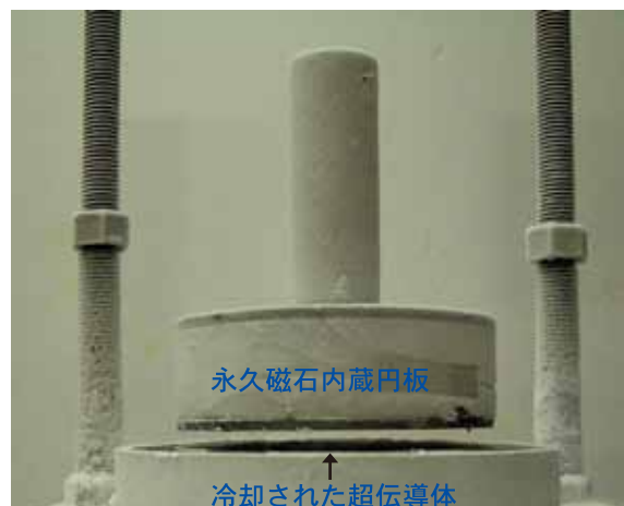
図1 超電導体の上で浮上している円板
