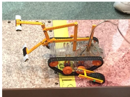
図4 中学生の部の特別賞受賞のサンプルリターン車。アームでサンプルを上下から挟み込む構造を持つ。クローラ両側のアーム状ホイールは、岩場でのスタック回避や急なターンを狙って設定している。各チームとも、岩場走行に苦労していた。
