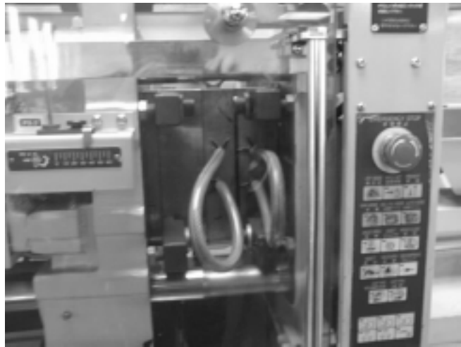
図2 射出成形機に取り付けられた金型
