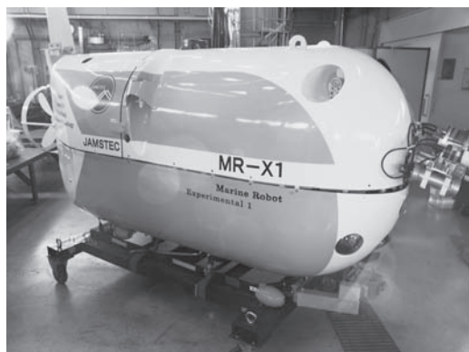
図10 作業型自律探査機「MR-X1」
