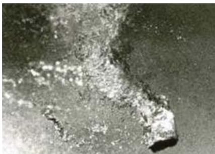
オリフィス下流に激しい損傷を生じる微細気泡列
