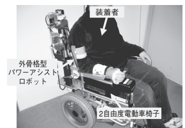
図2 3自由度上肢運動支援パワーアシストロボット [佐賀大学 木口量夫研究室]
