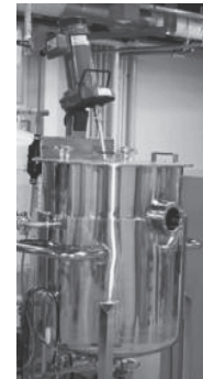
図3 研究用発酵槽(容積100L)
