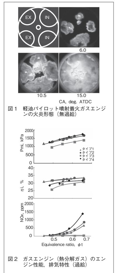
図1 軽油パイロット噴射着火ガスエンジンの火炎形態 (無過給)
