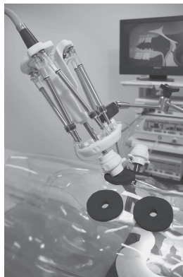
図3 試作機が内視鏡を把持位置決めしている様子
