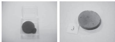
(a)コバルト酸カルシウム (b)アルミドープ酸化亜鉛 図2 生成した熱電酸化物
