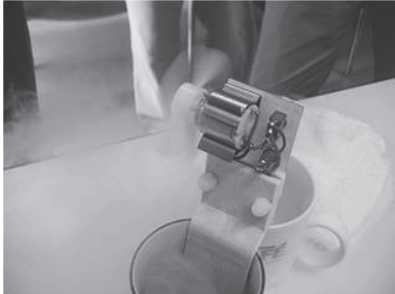
図1 熱電発電の様子(牧野研究室(京都大学)にて) 熱電半導体による熱-電気直接発電で小型モーターが回転している。
