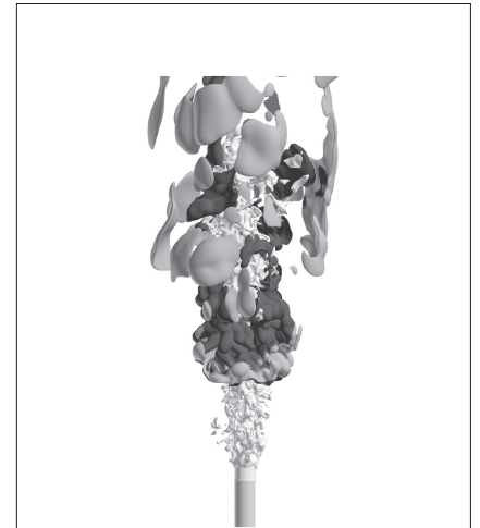
図1 浮き上がり火炎の構造(白:水素噴流, 濃淡色:予混合火炎, 淡灰色:拡散火炎)
