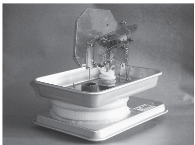
図1 最初に氷と湯の併用で駆動した試作品
