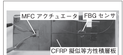
図1 CFRP積層板と一体化した広帯域超音波伝播システム
