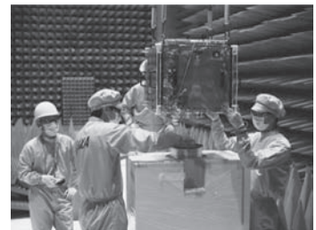
図2 衛星試験風景 (電磁適合性試験)
