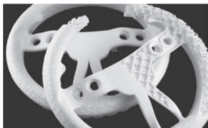
図4 中空化し軽量化を図ったソーラーカー用ステアリングのカットモデル
