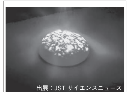
図1 アセチレンガスバーナによる燃焼試験中の KUMADAI 不燃マグネシウム合金の外観写真(沸騰しても発火していないことがわかる)
