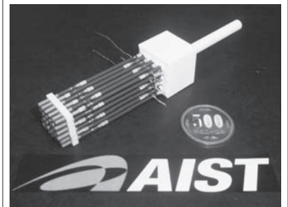
図 2 マイクロチューブ SOFC モジュール (直流 5~36V 仕様)
