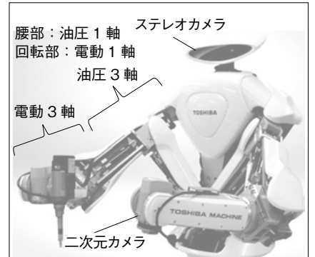
図1 開発したロボット外観
