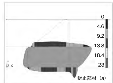
図2 傾斜角の違いによる封止部材の20万時間後の反発力の変化
