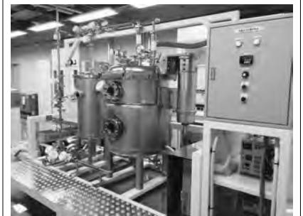
図3 汚染廃棄物の洗浄装置
