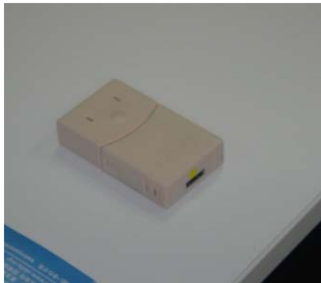
図3 サービス発見のための簡易デバイス USBでパソコンへ接続し情報をダウンロードすることが可能
