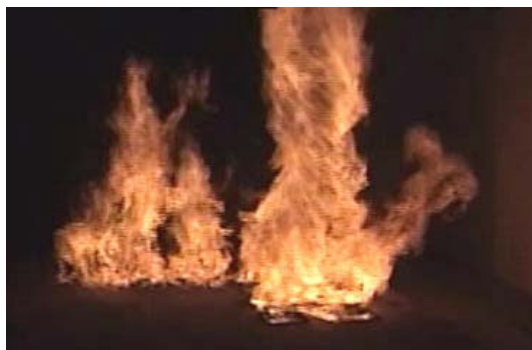
図 2 高さ 3m 以上に達した火災旋風
