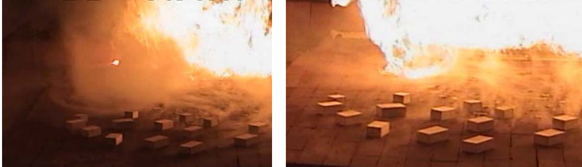
左：図3 燃焼域外に出現した炎を伴わない火災旋風 右：図4 燃焼域外に出現し、炎を引き込んだ火災旋風
