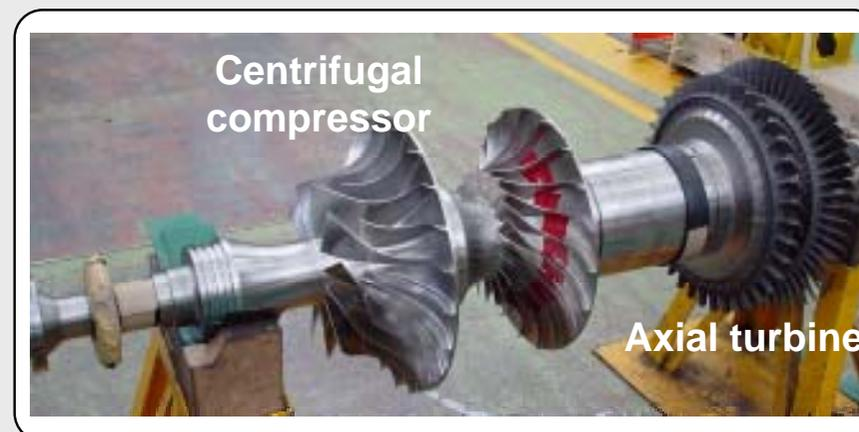
圧縮機: 遠心2段、タービン: 軸流2段
