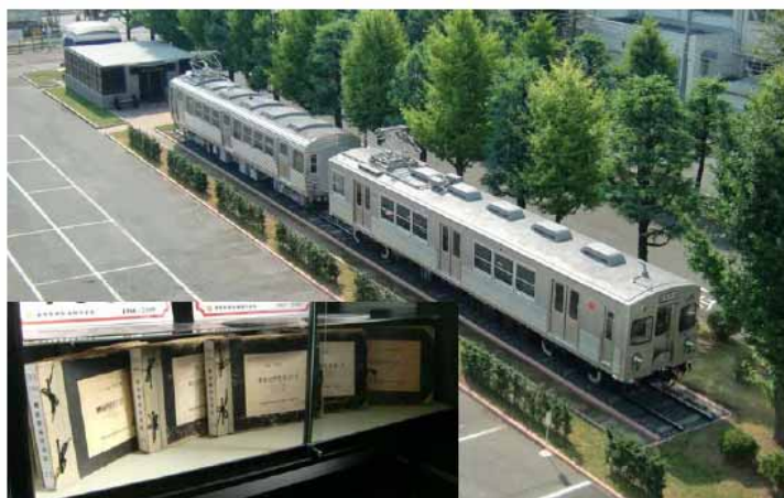
日本初のステンレス電車(東急デハ 5201・奥)、 日本初のオールステンレス車両(東急デハ 7052・手前) 及び設計関連図面(左下)
