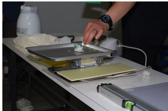
図4 大分大の加藤は新しいディスプレイサとディスプレイサチャンバも披露
