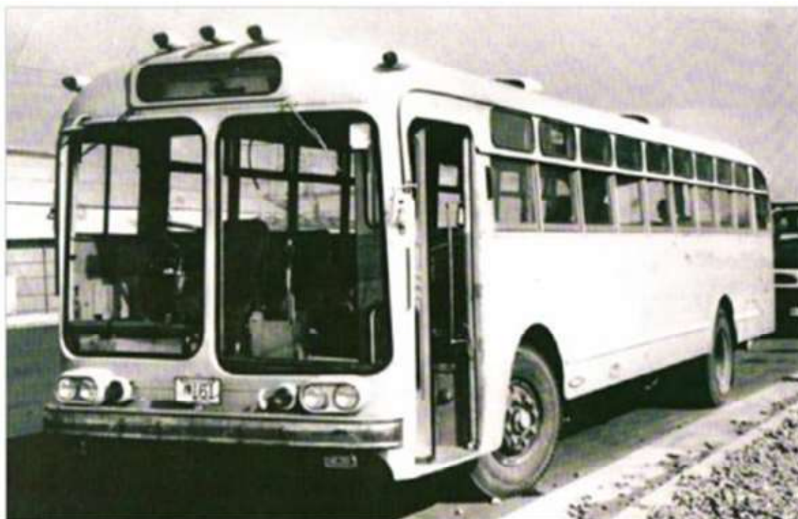
図1 巨大なフロントウィンドウの運転視界研究車両「三菱ふそうMAR820型改造車」
