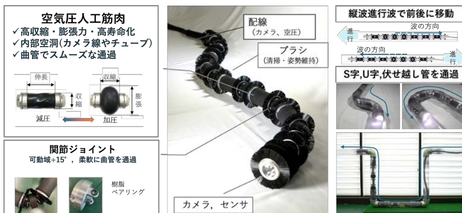
図1 受賞技術：蠕動運動型管内検査ロボット
