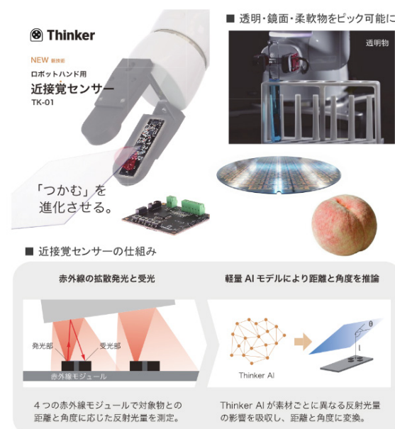
図1：(上) 近接覚センサの概観と（下）計測・処理イメージ
