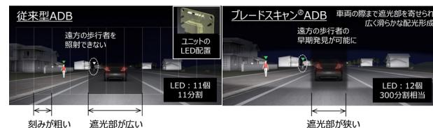
図3. 従来方式とブレードスキャン®ADBとの比較
