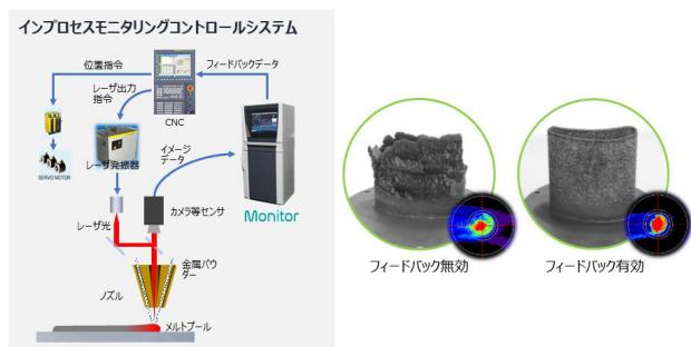
図4 モニタリングシステム構成とフィードバック効果
