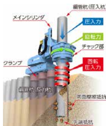
図2 ジャイロパイラーのしくみ
