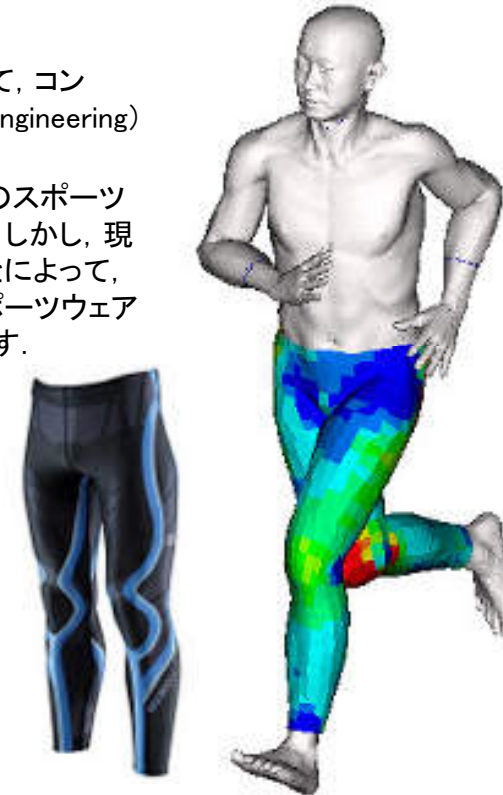
スポーツ用コンプレッションタイツとCAEを用いた応力の可視化
