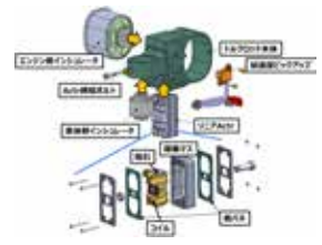
図4 新開発の慣性マスタクチュエータ
