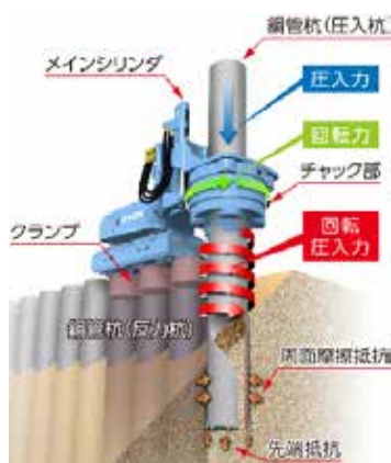
図2 ジャイロパイラーのしくみ
