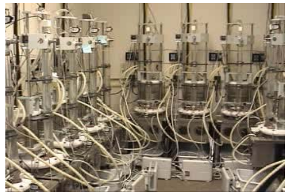
図 2 循環・拍動環境下での耐久性試験
